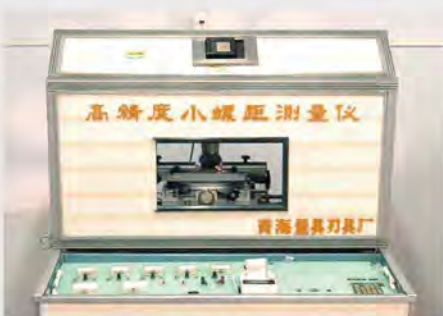
高精度小螺距测量仪
