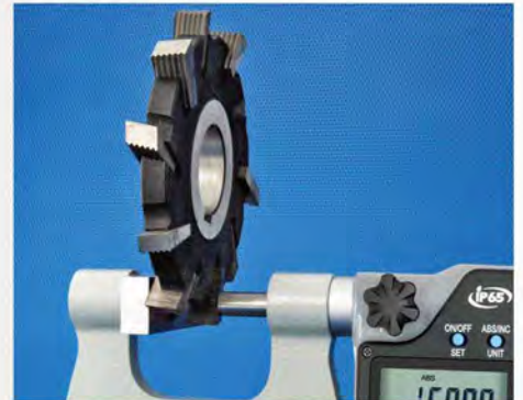
测量盘铣刀刀刃宽度
