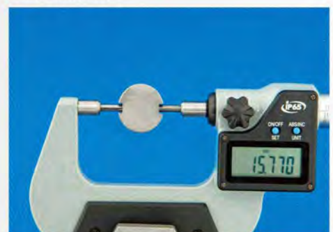
测量键槽根部尺寸
