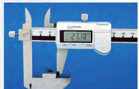
测量零件台阶尺寸
