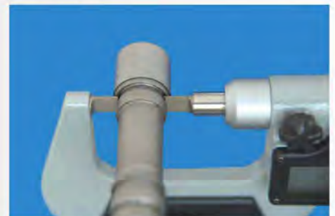
测量零件槽尺寸
