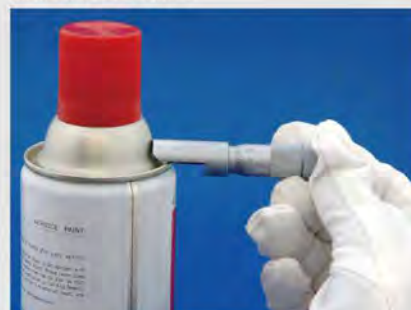
测量喷雾罐边缘尺寸
