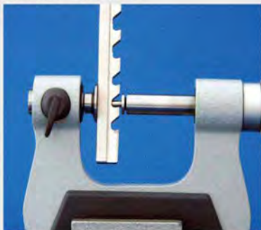
测量异形零件根部尺寸
