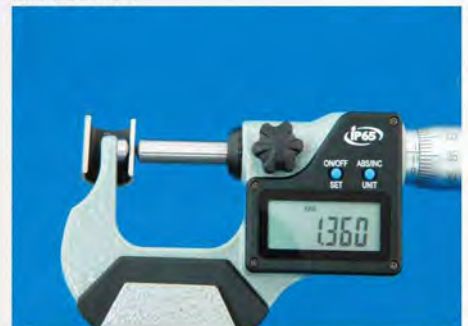
测量异型零件根部尺寸
