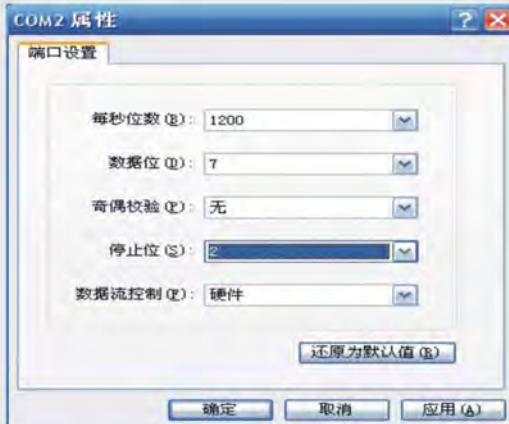
超级终端下com口设置
