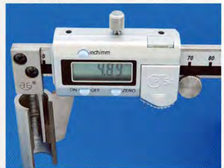
测量管壁厚度
