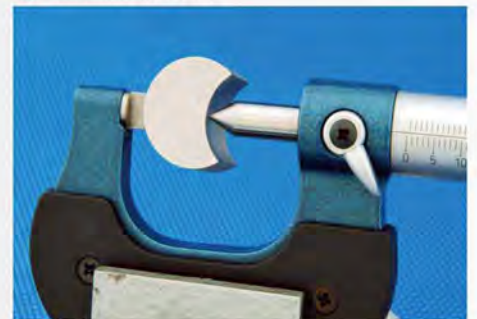
测量异形零件根部尺寸
