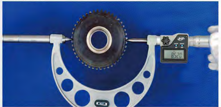
测量齿根圆直径
