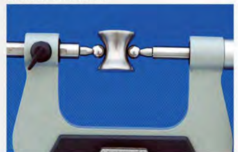
测量异形零件根部尺寸
