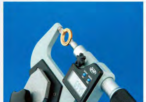
测量零件槽尺寸
