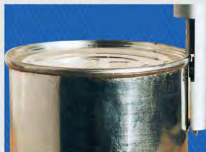
测量铁罐边缘尺寸
