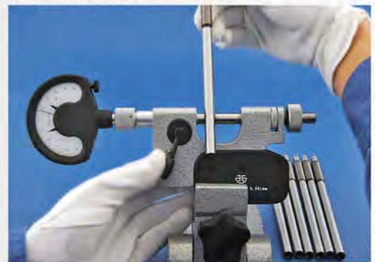
比较测量批量零件的直径
