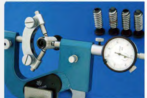
比较测量螺纹中径
