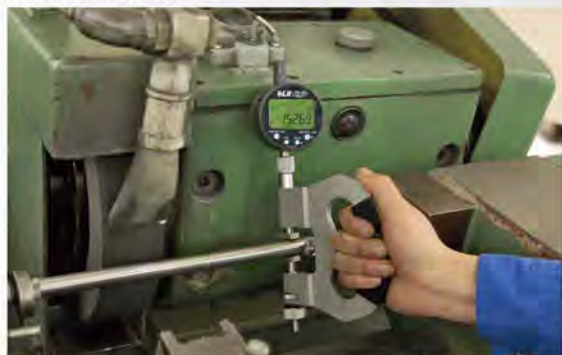
现场测量零件直径
