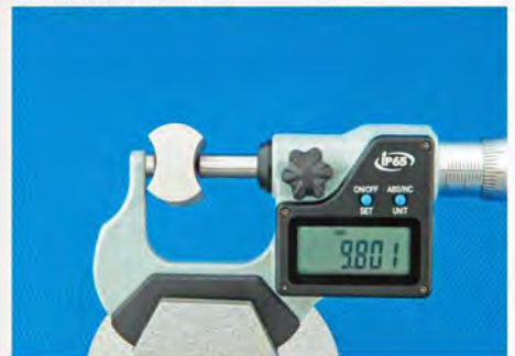
测量异型零件根部尺寸
