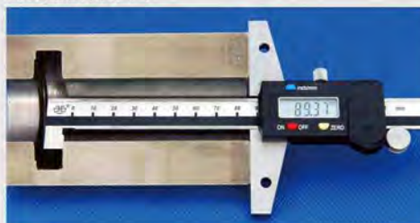
测量内槽深度尺寸
