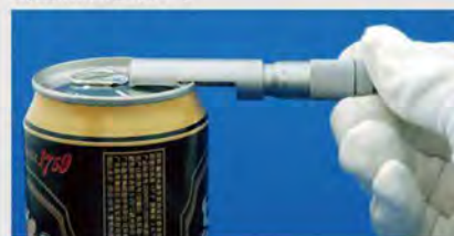
测量铝罐边缘尺寸
