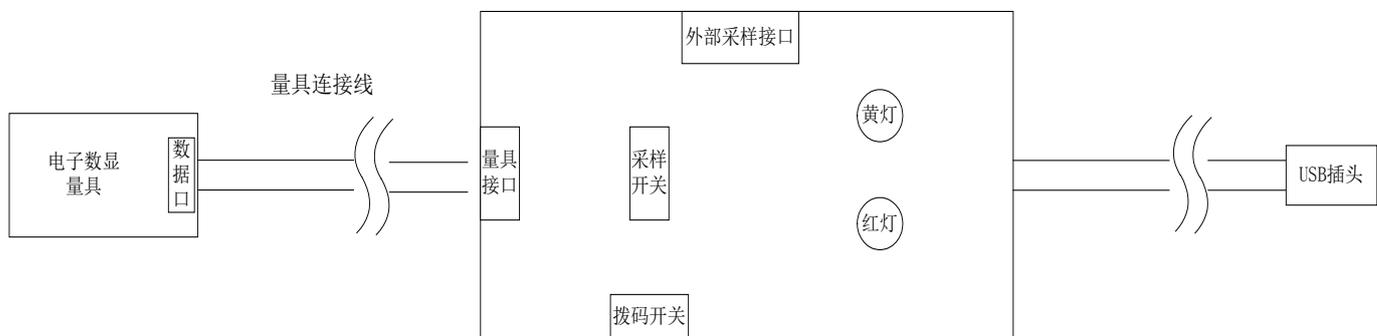
①量具连接线：用户根据自己所使用的电子数显量具的种类选择相应的连接线缆。该线缆一端连接量具的数据口，另一端连接适配器的量具接口。
